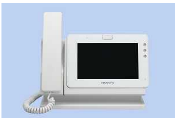
アンドロイド端末:充電台設置時はハンドセットにより通話可能
